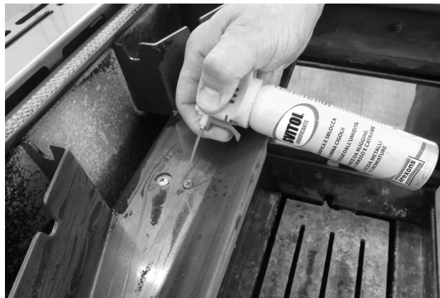
Fig. 32 - Liquide débloquant
