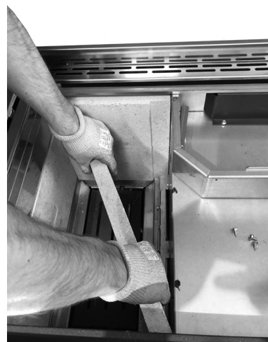
Fig. 40 - Retirer le matériau réfractaire
