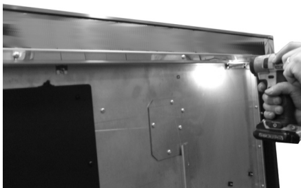
Fig. 44 - Retrait des vis
