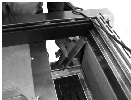
Fig. 36 - Retirer le profil
