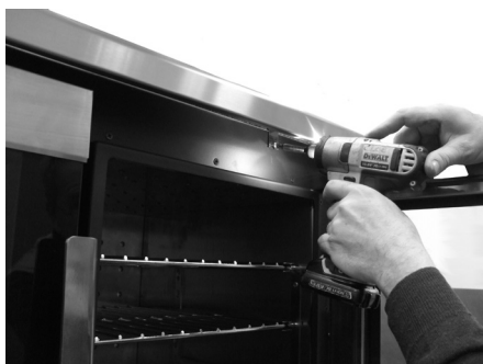
Fig. 43 - Retrait des vis
