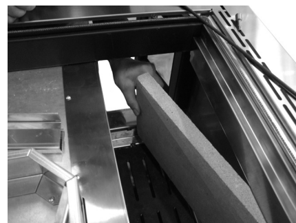
Fig. 37 - Retirer le matériau réfractaire
