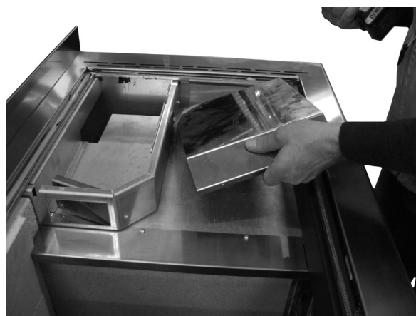
Fig. 19 - Retirer le déflecteur
