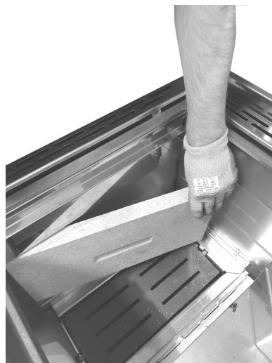
Fig. 42 - Retirer le profil
