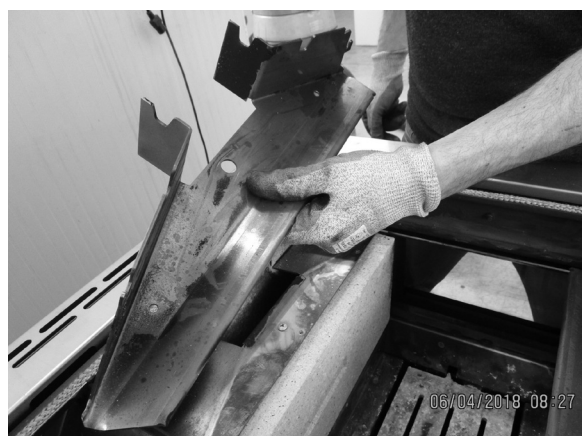
Fig. 34 - Retirer le profil
